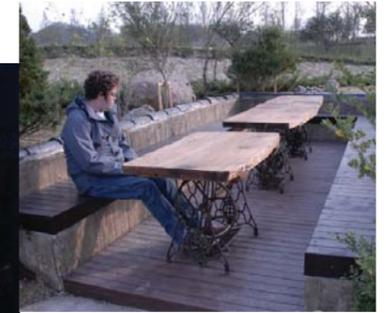
Principe de tables et banquettes du : piètement et ossature en acier galvanisé et peint, et lames bois
