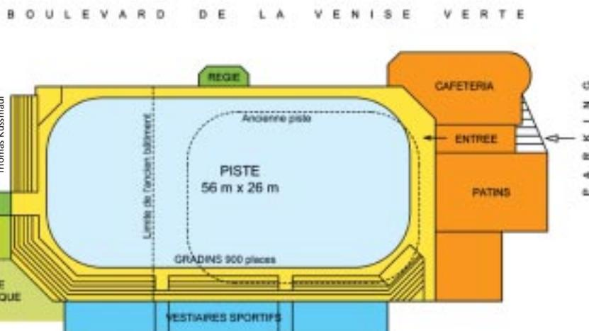
Plan du rez-de-chaussée agrandi (voir la limite du bâtiment actuel) et entièrement réaménagé pour être plus fonctionnel et accessible aux handicapés.
